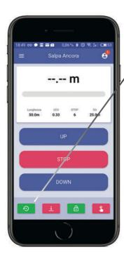
Nei salpa ancora predisposti, dotati di campana per la cima, è possibile attivare la funzione tonneggio attraverso l'uso dell'MFC.
