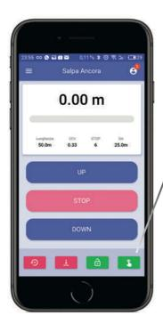
I tasti comando UP / DOWN posti sull'interfaccia dell'MFC, sono stati studiati per avere una doppia funzione ovvero, l'utilizzo standard come interruttore On/Off o l'utilizzo come pulsante Push/Pull.
