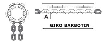
Tramite questa procedura si determina la misura di catena che è svolta ad ogni giro del barbotin.
